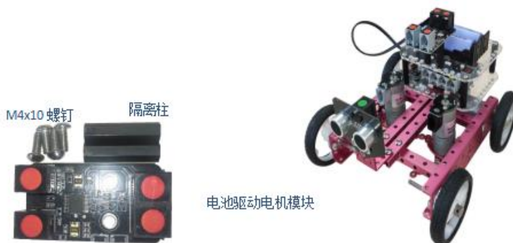
图 15 安装电池驱动电机模块
