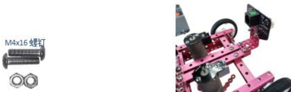
图 14 安装超声波传感器
