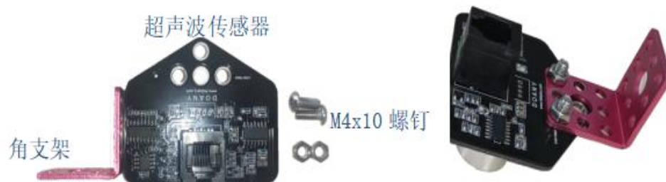
图 13 组装超声波传感器
