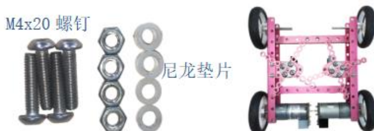
图 8 扫地装置安装
